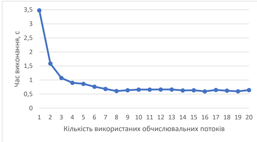
Рис. 3. Час роботи алгоритму на процесорі Intel i7
