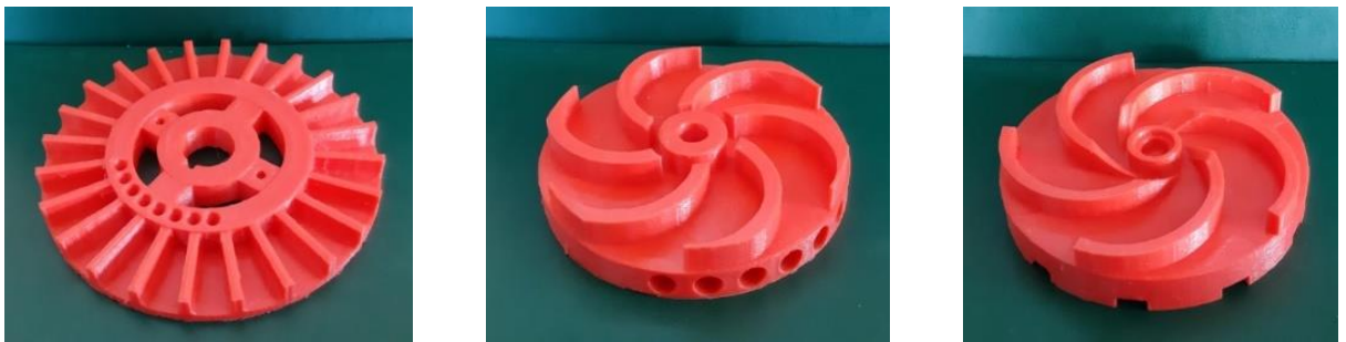
Рис. 4. Макеты колес центробежных насосов, выполненные на 3D-принтере
