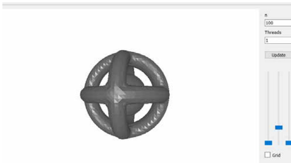
Рис. 4. Візуалізація геометричного об'єкта за допомогою «маршируючих кубів»
