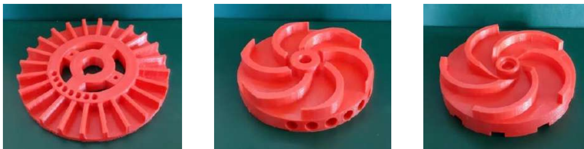
Рис. 4. Макеты колес центробежных насосов, выполненные на 3D-принтере
