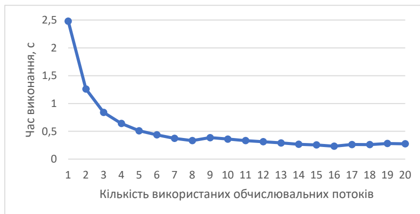
Рис. 2. Час виконання паралельного алгоритму візуалізації геометричної області «Атом» при різній кількості задіяних потоків на процесорі AMD Ryzen
