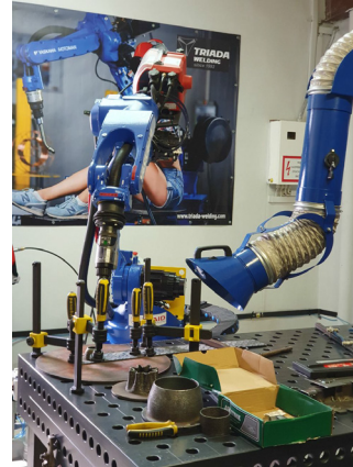
Рис. 1. Процес адитивного виробництва з використанням електродугового зварювання на ТОВ «Тріада ЛТД Ко»
