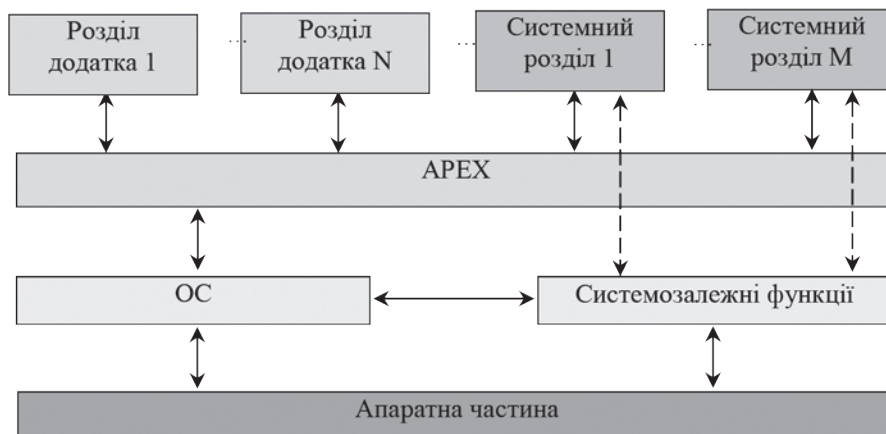
Рис. 1. Архітектура модуля за стандартом ARINC-653
