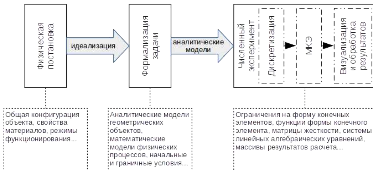
Рис. 1. Схема конечно-элементного анализа
