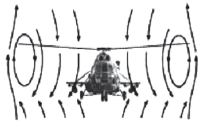
Рис. 1. Формування вихрового кільця на режимі вертикального спуску, V = 3-5 м/с
